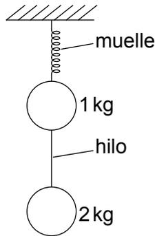
Si se corta el hilo, ¿cuánto valdrán los módulos de las aceleraciones de los objetos inmediatamente después del corte en función de la aceleración debida a la gravedad  $g$ ?
